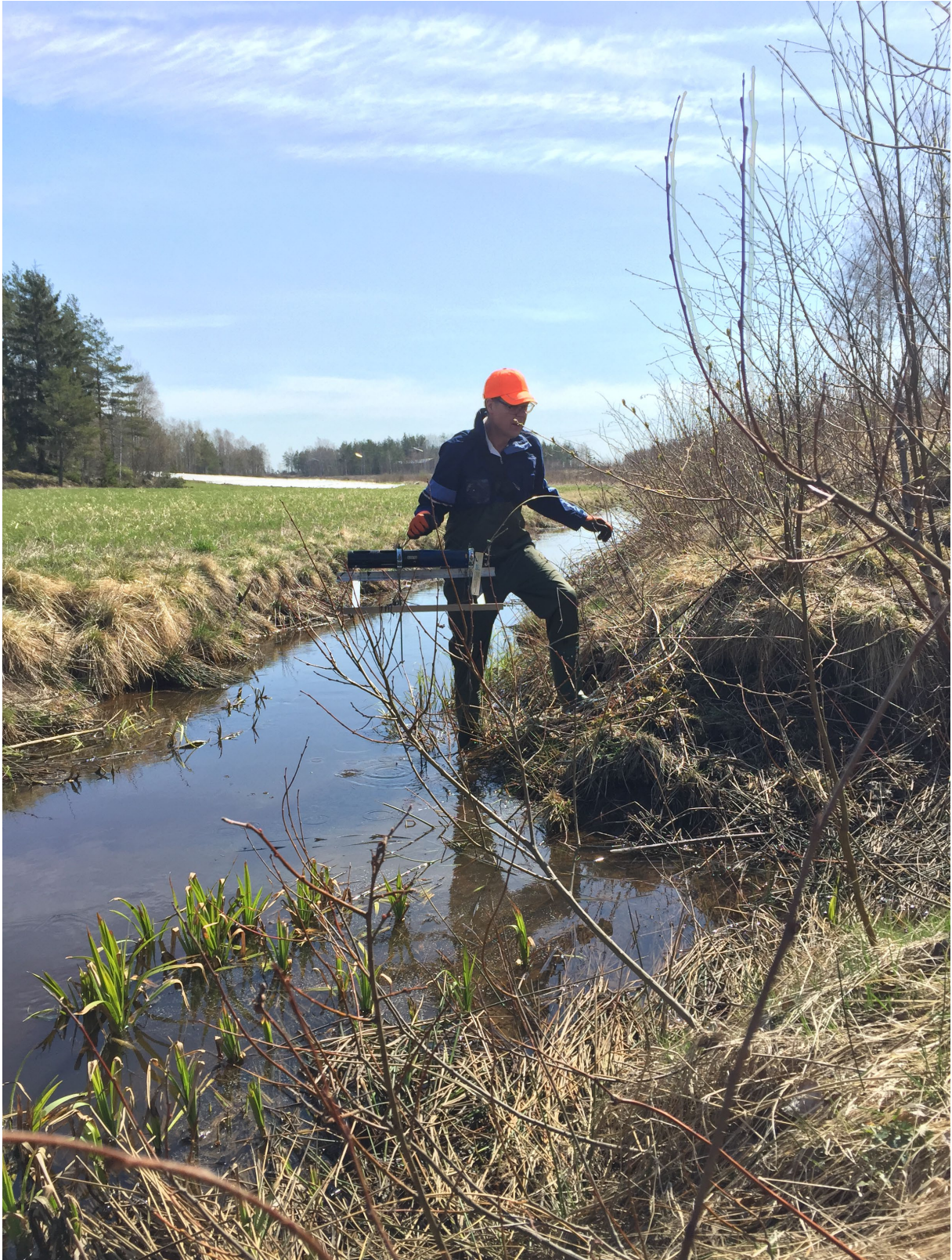
Kuva 1. Vedenlaatua tarkkailtiin Mourunojassa kolmessa pisteessä automaattisella vedenlaadun mittarilla.
